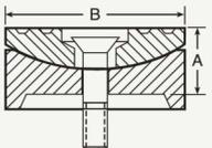
Zur Reduzierung der Einwirkungen aufermittiger Belastung. Maximaler Neigungswinkel von 5°. Radiale Rillen auf der Oberfläche des Druckstücks verringern die Gefahr des Verrutschens bei aufermittiger Belastung.
